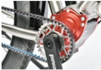
Üppiges Gangspektrum: Pinion-Getriebebeschriftung P1.18.
