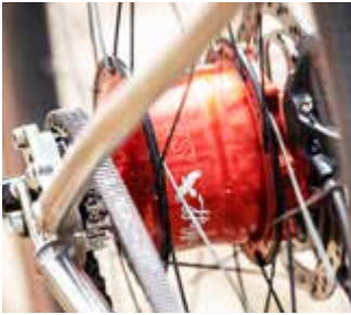
Schalt- und Bremszüge laufen dezent in das Steuerrohr. Unten: Einzigartig: Rohloff-Getriebe und Carbonriemen am Gravelbike.
