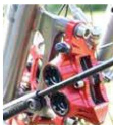
Die Hope-Bremse mit Stahlflexleitung ist eine Macht! Hebelweite und Druckpunkt lassen sich einstellen
