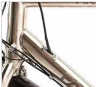
Die Gebra-Schaltbox ermöglicht es Rohloff, mit Rennradhebeln zu schalten. Unten: Hochwertig und fein verarbeiteter Titanrahmen.
