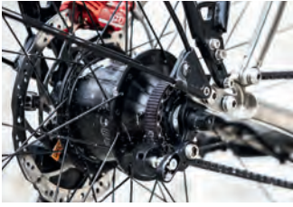
Langlebig und wartungsarm: die Rohloff E-14 Nabenschaltung.
