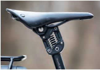
Top-Ansprechverhalten: die Parallelogramm-Federsattelstütze.
