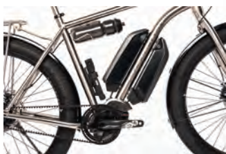
Top S-Pedelec-Antrieb: Performance Line Speed mit Riemen.
