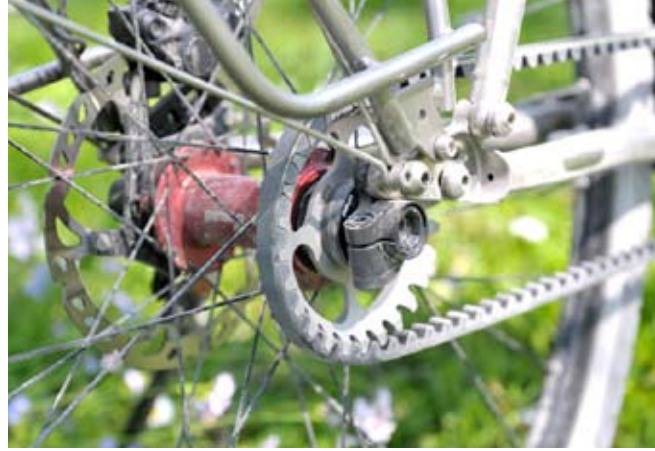
Feines Ende: Pinion-Nabe mit zugegeben lautem Freilauf, Conti-Riemensystem mit Edelstahl-Scheibe und das Ausfallende mit Steckachse. Der feine Staub macht all dem nichts aus.
