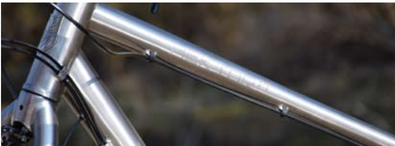
Hier sieht man gut das keulenförmige Oberrohr. Es war mal ange-dacht, die Reiseräder Hektor zu nennen. Aus der Zeit stammt unser Testrahmen. Jetzt heißen sie Hoplit.
