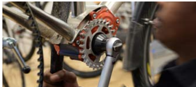
Umbau auf den Riemenantrieb im neuen Test-center von Falkenjagd.
