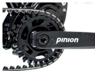
Der Riemen läuft mit sehr geringer Vorspannung
