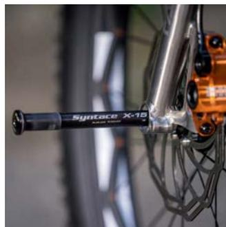
1. Ein Aufwand, den im Titanbereich kaum jemand betreibt, sind die diversen geschmiedeten Rahmenbauteile, wie hier die **PM-Bremsaufnahme**. 2. **Bis ins kleinste Detail:** Neben Rahmen fertigt man auch Vorbauten, Sattelstützen, Spacer und sogar Schrauben aus Titan. 3. **Innovationstreiber:** Zusammen mit Syntace hat man die X-15-Steckachse überarbeitet und ihr ein Feingewinde und einen verjüngten mittleren Bereich verpasst.
