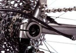
Fast nahtlos fügt sich das Ausfallende in den Titan-Hinterbau des Aristos. Per Achs-Exzenter lässt sich auch die Spur des Hinterrads exakt ausrichten
