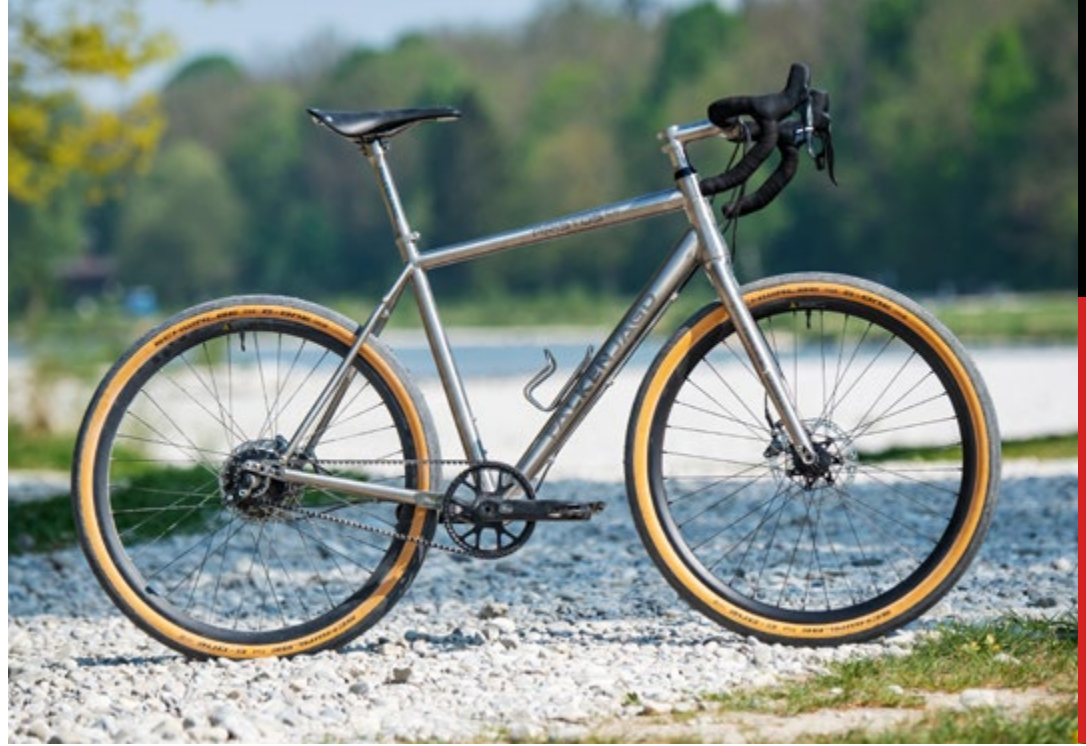
Rohloff-Slider mit Flat-Mount-Aufnahme und Gebla-Rohbox. Unten: Platz und Ösen für Schutzbleche und Licht vorhanden.
