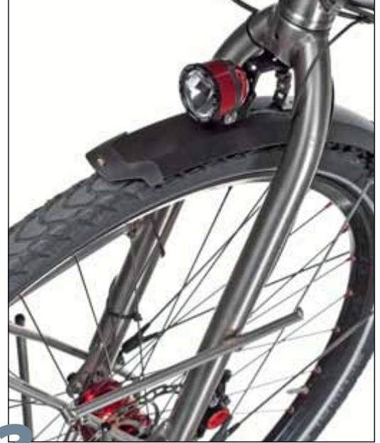
**2 Flexibel** Die komplette Gabel besteht aus Titan. Dadurch federn Gabelscheiden und -schaft enorm. Die Lenkpräzision mit Gepäck leidet aber.
