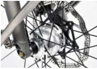
Der feine SON-Dynamo befeuert die Supernova Lichtanlage.
