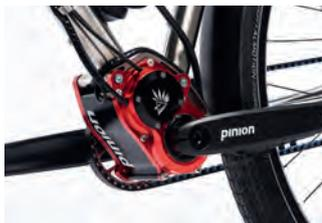
Harmoniert top mit NeoDrives: das Pinion Tretlagergetriebe.
