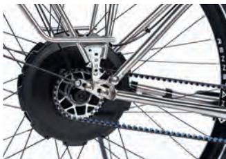
NeoDrives-Heckantrieb Z2o mit 40 Nm max. Drehmoment.
