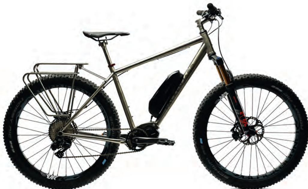
Clou: Hinterbau asymmetrisch, Hinterrad symmetrisch gespeicht.
