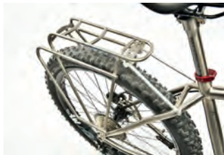
Clou: Hinterbau asymmetrisch, Hinterrad symmetrisch gespeicht.
