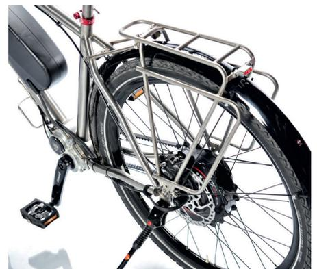
Der GO SwissDrive 250-Watt-Heckmotor ist mit einem Riemenantrieb kombiniert.
