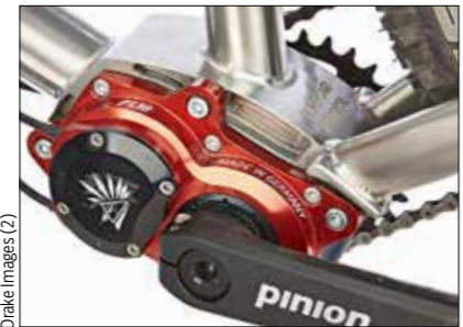
Die nahezu wartungsfreie Pinion-Getriebekurbel stellt 18 fein abgestufte Gänge mit breitem Übersetzungsspektrum parat.
