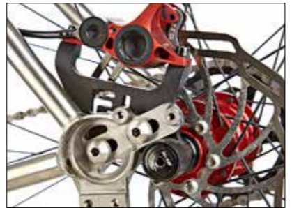
Wunderschönes Titan! Die „Slider“-Ausfallenden mit Aufnahme für Scheibenbremse und X12-Steckachse sind ein Blickfang.
